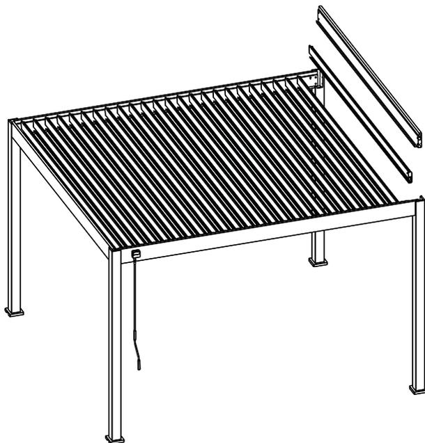
Поместите трансформатор в удаленную боковую балку, протяните входной кабель трансформатора через дренажное отверстие в столбе и разместите выходной кабель сверху.
