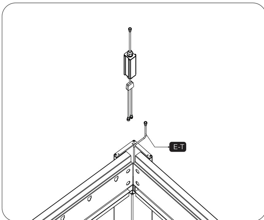
Подключите контроллер к трансформатору, выведите провод контроллера как на рисунке для облегчения последующего подключения светодиодной полосы.
