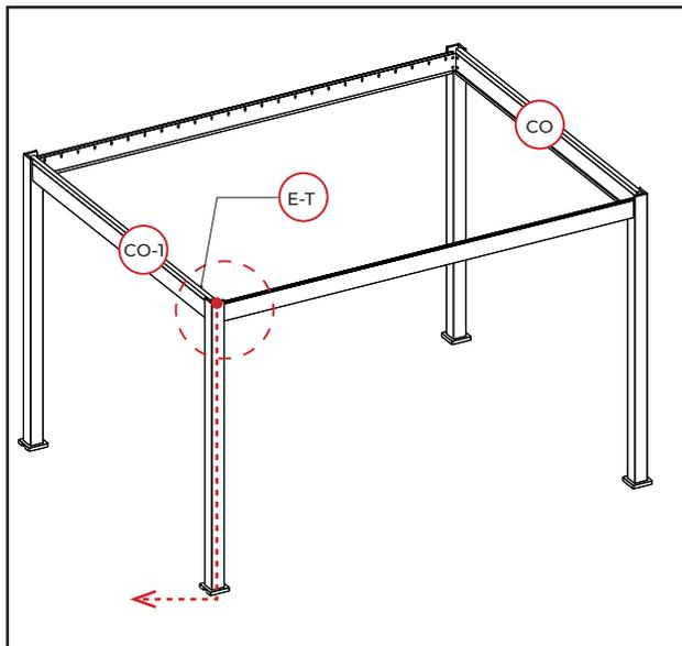
Вставьте трансформатор в полость детали CO-1 таким образом, чтобы оставить достаточно длины силового кабеля.
