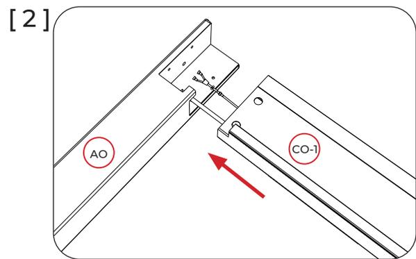
Соедините балку (CO-1) со стойкой (AO) согласно схеме, приведенной ниже. Не забывайте держать силовую кабель (E-P) снаружи балки.
