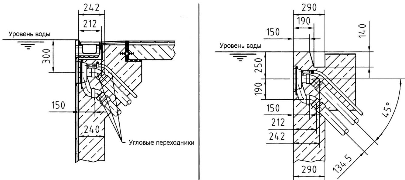
При глубоком или низко расположенному желобе необходима приостановка его работы. В этом случае расстояние между уровнем поверхности и форсункой должно составлять 200-250 мм.
