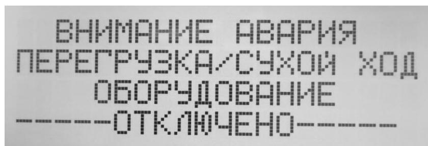
*Примечание: В случае "Сухого хода", пульт управления «AVO-01», перед тем как выйти в режим аварии, три раза попытается прокачать насос фильтровальной установки.*
