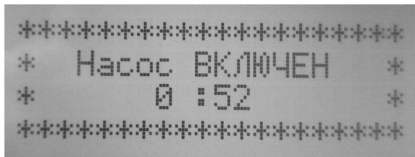
В связи с отключением автоматики защиты, использовать данный режим необходимо с осторожностью. Следите за наличием воды в насосе фильтровальной установки. В случае ее отсутствия нужно немедленно выключить панель управления.
