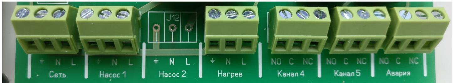
К клемме **СЕТЬ** подключается три кабеля питания. Запрещается менять местами «Фазовый» и «Нулевой» провода. Подключать нужно в точности в соответствии с рисунком.
