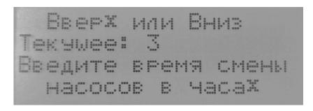
Если установить время смены насосов **больше** установленного интервала работы, смены насосов не произойдет.
