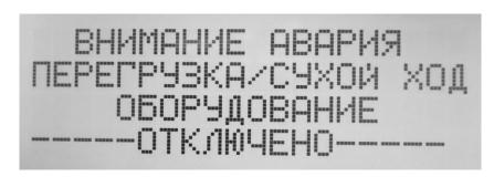
Чтобы выйти в нормальный режим работы необходимо выключить панель управления, устранить причину аварии, включить панель и выбрать пункт меню : «Работа», либо подождать 60 секунд до автоматического запуска.
