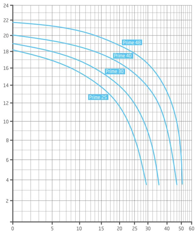
Напор H (m) / Поддача Q (m³/h) >
