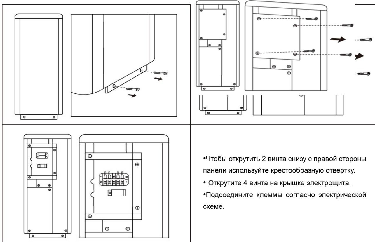
**⚠ 2. Схема электрической проводки**
