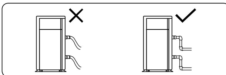
2.1.2. Для обеспечения гарантированной тепловой производительности длина водопровода должна составлять  $\leq 10$  м между бассейном и тепловым насосом.
