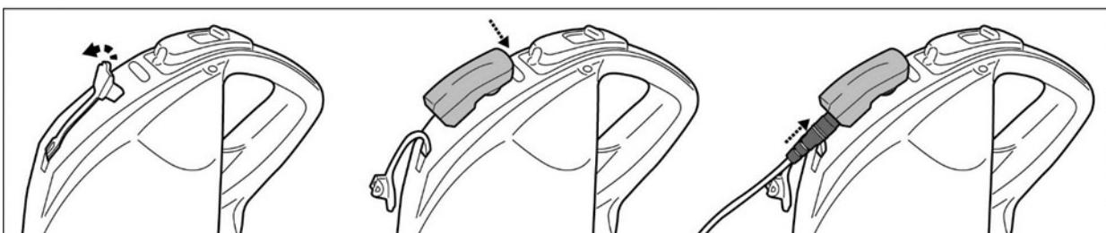
3. Conecte el adaptador externo a la fuente de alimentación. El indicador LED del adaptador externo se vuelve rojo después de que comienza la carga. El indicador LED del adaptador externo se vuelve verde cuando el robot esta cargado.
