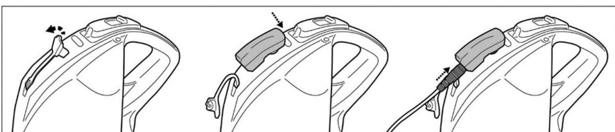
3. Verbinden Sie den externen Adapter mit der Stromquelle. Die Anzeigeleuchte am externen Adapter leuchtet rot, sobald der Ladevorgang beginnt. Die Anzeigeleuchte am externen Adapter leuchtet grün, wenn der Roboter aufgeladen ist.
