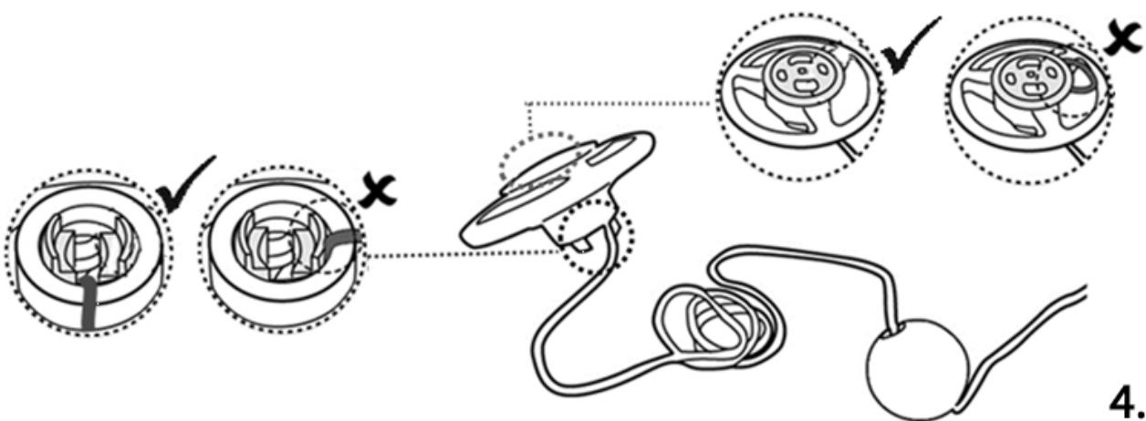
2. Не включая пылесос, погрузите его в бассейн и осторожно встряхните несколько раз, чтобы облегчить выход воздуха. Избыток воздуха в корпусе может привести к хаотичной работе поворотной головки (например, многократное вращение в бассейне в течение нескольких минут).
