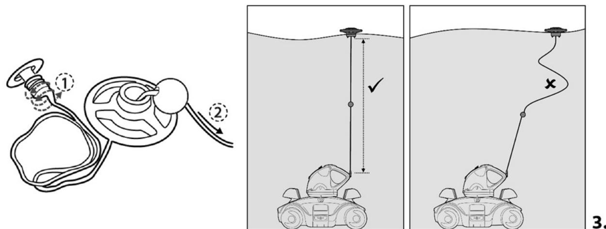
Nach Erreichen der gewünschten Länge fixieren Sie diese, indem Sie das Seil gegen die Hülse halten und diese wie dargestellt durch Drücken des seitlichen Clips wieder befestigen.
