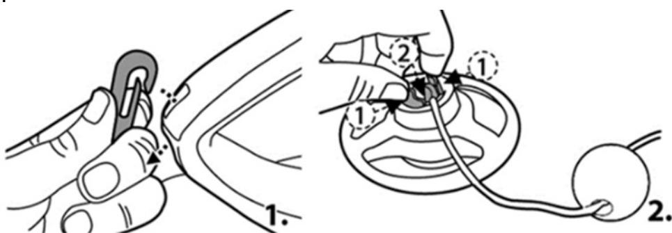
Lösen Sie die Leine an der Hülse auf eine Länge, die dem Abstand zwischen dem Handgriff des Roboters und dem Wasserspiegel entspricht. **HINWEIS:** Überlänge kann die Leine knicken und dadurch die Leistung beeinträchtigen
