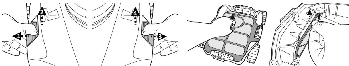
2. Снимите крышку фильтра и удалите мусор из отсека. Рекомендуется чистить сетку фильтра и фильтрующую пластину проточной водой. Если необходима механическая чистка, используйте только мягкую щетку. Проводите чистку мягко и аккуратно, чтобы избежать повреждений.
