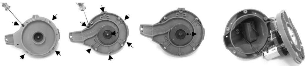
3. Выньте аккумуляторный блок, чтобы открыть РСВА. Чтобы отсоединить провод подключения аккумулятора, нажмите на зажим на разъеме, а затем извлеките его. **ПРИМЕЧАНИЕ.** Немедленно оберните разъем изоляционной лентой, чтобы избежать короткого замыкания, вызванного контактом обоих клемм.
