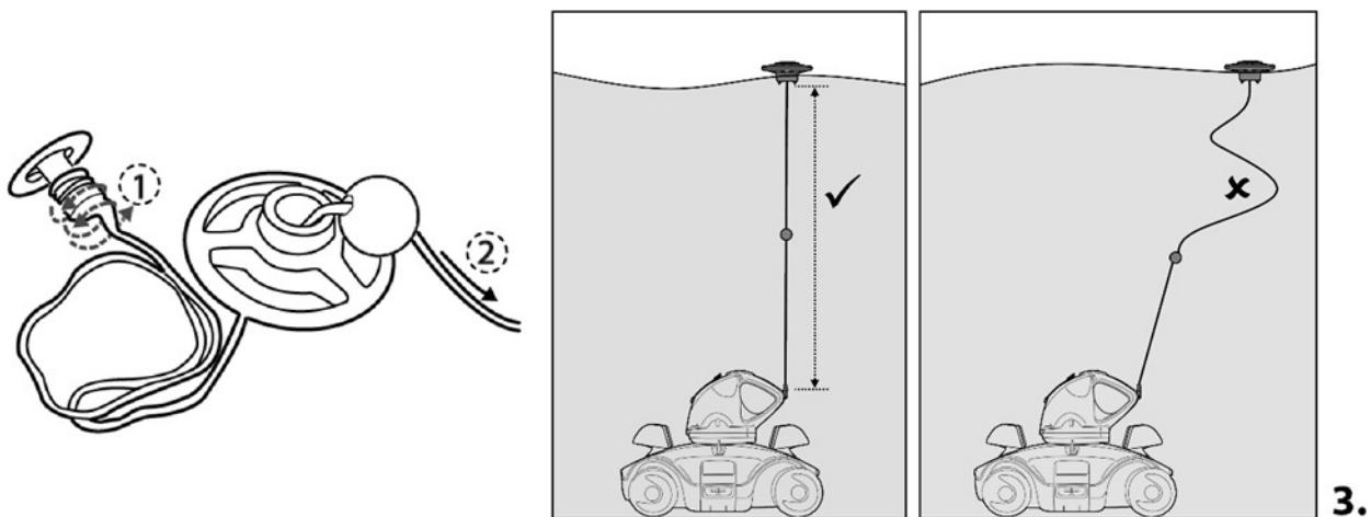
Una vez alcanzada la medida deseada, manténgala sujetando la cuerda sobre el tubo y vuelva a fijarlo al flotador presionando el clip lateral, tal como se muestra.
