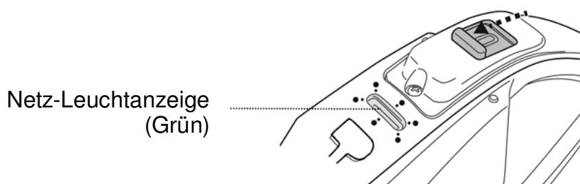
3. Schieben Sie den Netzschalter auf ON (während der Roboter noch untergetaucht ist) - die Kontrollleuchte leuchtet auf und aktiviert den Motor automatisch (Wasserstand, der die Sensoren am oberen Ende des Schwenkkopfes bedeckt). Lassen Sie den Roboter auf den Beckenboden sinken und beobachten Sie seine ersten Vorwärts- und Rückwärtsbewegungen über den Beckenboden. Läuft er an der Beckenwand entlang
