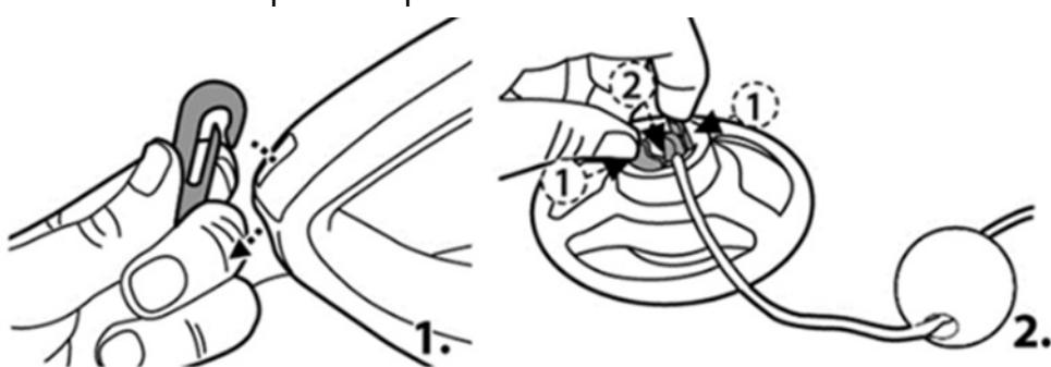
Suelte cuerda de recuperación del tubo hasta disponer de una longitud equivalente a la distancia entre el mango del limpiafondos y el nivel del agua. NOTA: Un exceso de longitud podría retorcer la cuerda y afectar al rendimiento del aparato.
