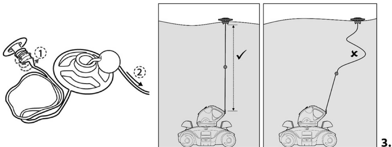
После достижения желаемой длины поддерживайте ее, удерживая веревку на стержне, и прикрепите ее к поплавку, нажав на боковой зажим, как показано на рисунке.
