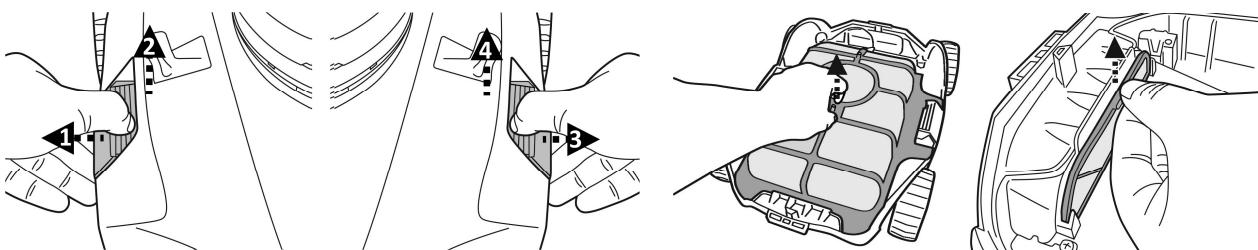
2. Verwijder het vuil uit de bak. Het is raadzaam het gaas van het filterdeksel en de drainage filterplaat met spatwater schoon te maken. Als dat niet volstaat, kunt u een zachte borstel gebruiken om het vuil voorzichtig te verwijderen. Oefen GEEN druk uit op het gaas.
