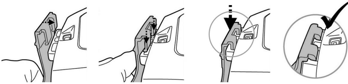
TIPP: Die beiden Hakenenden drücken, um den Abstreifer bzw. die Bürste zu entfernen.
