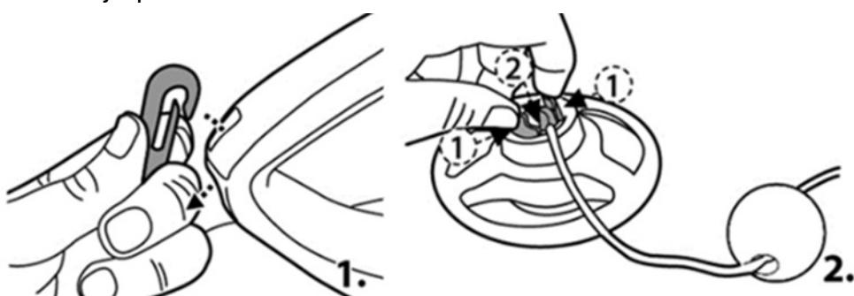
Maak het ophaalkoord van de steel los tot een lengte die gelijk is aan de afstand tussen het handvat van de robot en het waterniveau. **OPMERKING:** Overtollige lengte kan het touw doen knikken en zo de prestaties beïnvloeden.
