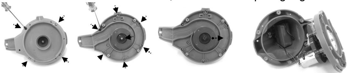
3. Akku herausnehmen, so dass PCBA zugänglich ist. Um die Anschlussdrähte vom Akku zu lösen, auf den Clip am Stecker drücken und dann herausziehen. HINWEIS: Umwickeln Sie den Stecker sofort mit Isolierband, um einen Kurzschluss durch einen Kontakt der beiden Drahtenden zu vermeiden
