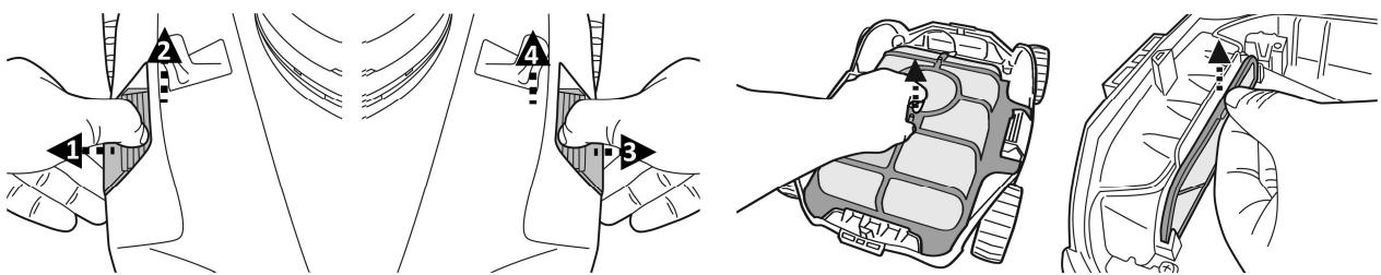
2. Reinigen Sie das Schmutzfach. Es wird empfohlen, das Netz der Filterabdeckung und den Ablauffilterteller unter laufendem Wasser zu reinigen. Ist der Einsatz einer Bürste notwendig, verwenden Sie nur eine weiche Bürste und reinigen Sie damit vorsichtig. Üben Sie dabei KEINEN Druck auf das Netz aus.
