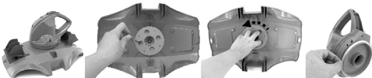
2. Use el destornillador para desatornillar los 4 pernos situados en la parte inferior del cabezal para liberar la placa inferior. Desatornille todos los pernos de la base, tal como aparece en la imagen. Retire el propulsor, tire de la base y sáquela para dejar el cabezal al descubierto.
