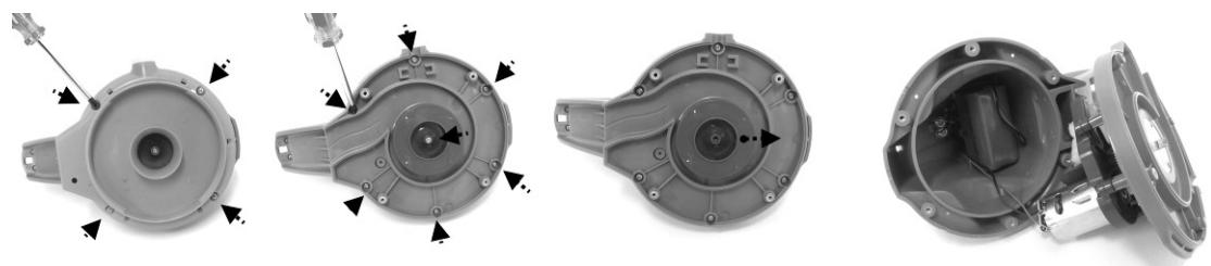
3. Estrarre la batteria per esporre il PCBA. Per estrarre il cavo di connessione della batteria, premere il gancio sul connettore ed estrarlo.
