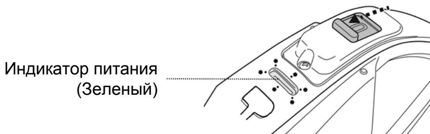
3. Погрузите пылесос в воду. Робот начнет работу автоматически, как только вода покроет датчики на поворотной головке. Позвольте пылесосу опуститься на дно бассейна. Понаблюдайте за первыми движениями пылесоса вперед и назад по дну бассейна. Если пылесос движется вдоль стены бассейна, а не перпендикулярно ей,
