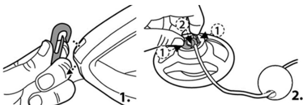
Отпустите веревку на длину, эквивалентную расстоянию между рукояткой робота и уровнем воды. **ПРИМЕЧАНИЕ:** Избыточная длина может привести к перекручиванию веревки и, как следствие, к ухудшению эксплуатационных характеристик.
