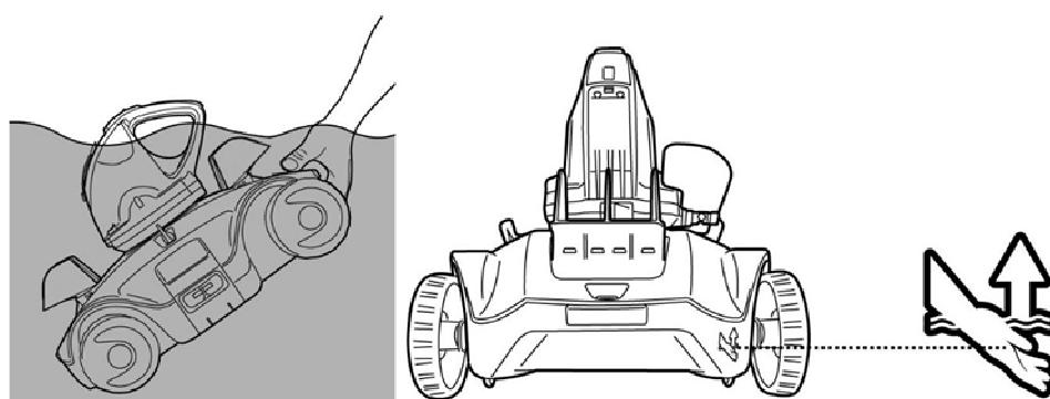
5. Schuif de schakelaar in de UIT-positie. Spoel de robot na elk gebruik met schoon water. Gebruik GEEN schoonmaakmiddelen.
