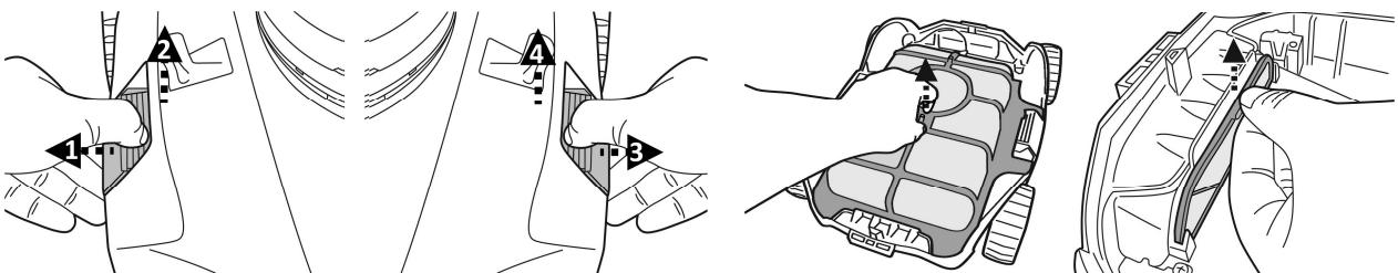
Pulire i detriti presenti nel filtro. Si raccomanda di pulire il coperchio del filtro e il piatto del filtro di drenaggio con acqua corrente. Se si ritiene necessario spazzolare, usare soltanto una spazzola morbida per pulirlo delicatamente e meticolosamente. NON applicare nessuna pressione sulla rete.
