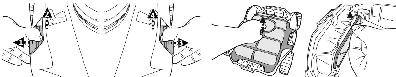
2. Vacíe los restos del compartimento del filtro. Se recomienda limpiar la red del filtro y la placa de drenaje del filtro con un chorro de agua. Si cree necesario cepillarla, use un cepillo suave para limpiarla con cuidado. NO aplique presión a la red.
