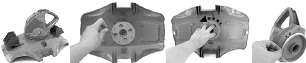
2. С помощью отвертки открутите 4 винта, расположенные в нижней части головки, чтобы сначала освободить нижнюю пластину. Затем открутите все винты на основании, как показано на рисунке. Снимите крыльчатку и откройте основание, чтобы освободить внутреннюю часть головки.
