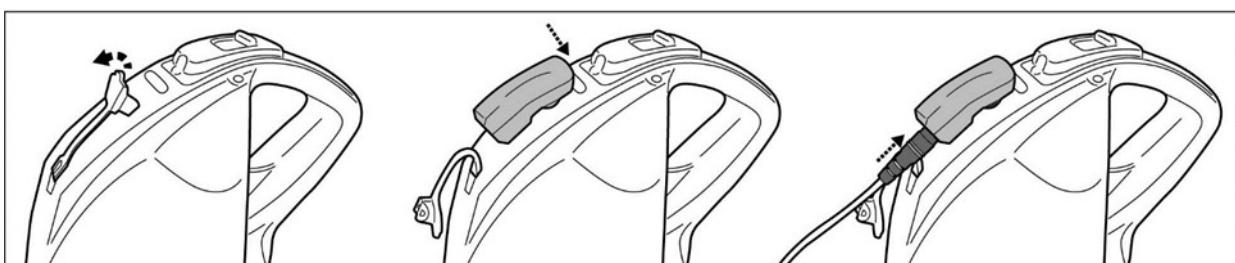
3. Collegare l'adattatore esterno alla fonte di alimentazione. L'indicatore luminoso sull'adattatore esterno diventa rosso una volta iniziata la ricarica. L'indicatore luminoso sull'adattatore esterno diventerà verde quando il robot è carico.
