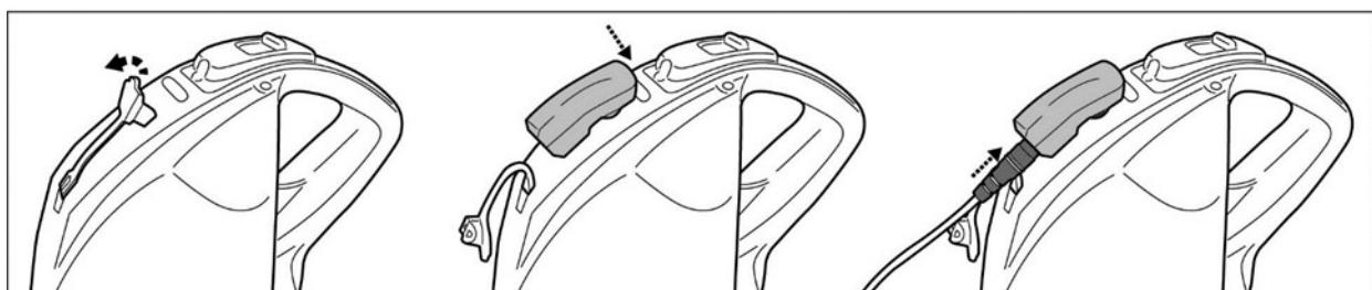
3. Steek de externe adapter in een stopcontact. Het indicatielampje op de externe adapter wordt rood als het laden begint. Het indicatielampje op de externe adapter wordt groen wanneer de robot is opgeladen.
