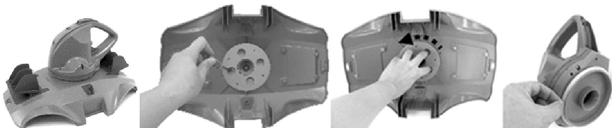
2. Gebruik de schroevendraaier om de 4 schroeven aan de onderkant van de kop los te schroeven om eerst de bodemplaat te verwijderen. Gebruik de schroevendraaier om alle schroeven op de basis los te draaien, zoals getoond wordt in de afbeelding. Verwijder de rotor, wruk de basis los en verwijder ze om tot de kop aan de binnenkant vrijkomt.
