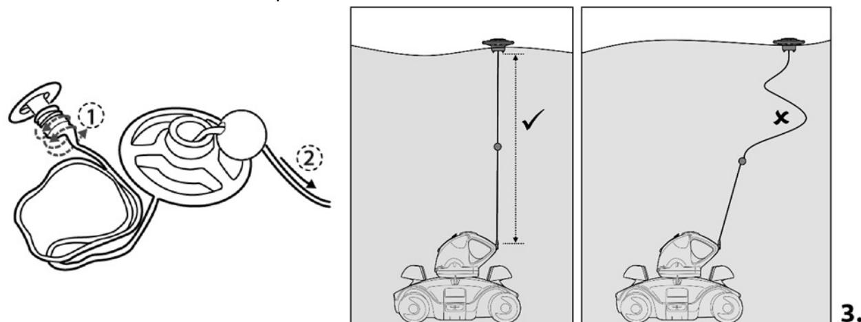
Als de gewenste lengte is bereikt, houdt u deze vast door het koord op de steel te klemmen en weer aan de vlotter te bevestigen door op de zijclip te drukken zoals aangeduid op de afbeelding.
