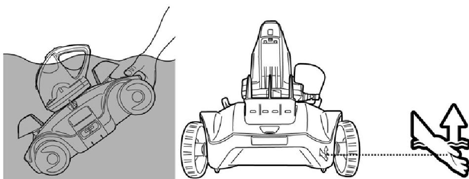
5. Schieben Sie den Schalter auf OFF. Spülen Sie den Poolroboter nach jedem Einsatz mit sauberem Wasser ab. Verwenden Sie dazu KEINE Reinigungsmittel.
