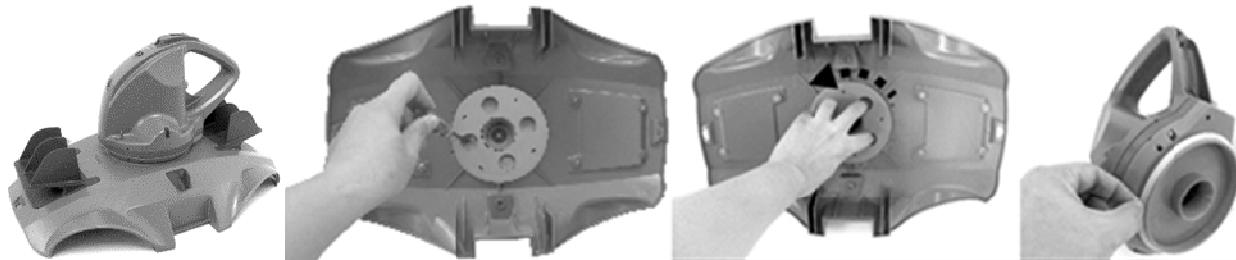
2. Usare il cacciavite per svitare le 4 viti collocate nella parte inferiore della testina per rilasciare il piatto inferiore. Usare il cacciavite per svitare tutte le viti presenti sulla base, come illustrato. Rimuovere la ventola e sollevare la base e rimuoverla per esporre la testina all'interno.
