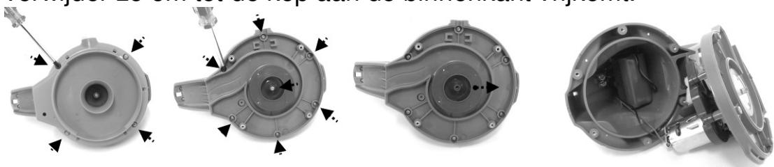
3. Verwijder de accu om bij de PCBA te kunnen. Druk op de clip van de connector en trek de connector weg om de voedingskabel van de batterij los te koppelen. NB: Wikkel onmiddellijk isolatieband rond de connector om kortsluiting tussen beide kabeluiteinden te voorkomen.
