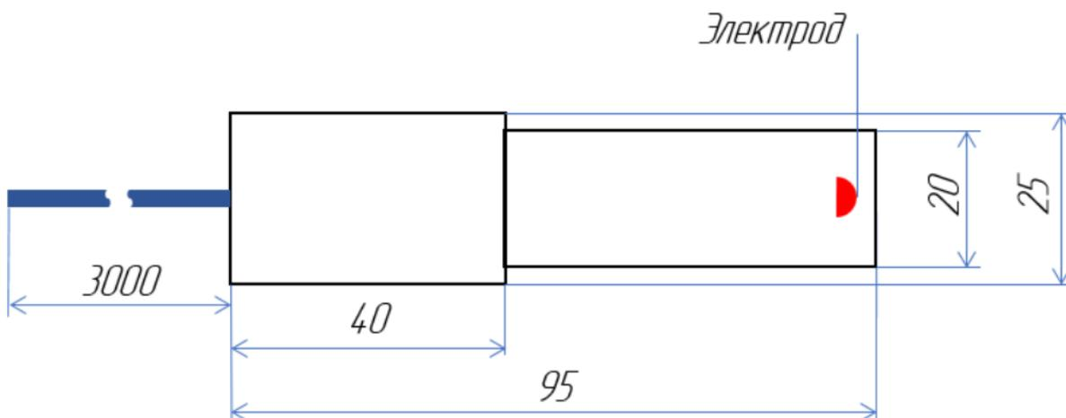
Корпус выполнен из ПВХ, электроды из нержавеющей стали марки AISI 304. Датчик устанавливается в балансном или промежуточном резервуаре, или в другом подходящем для этого месте.
