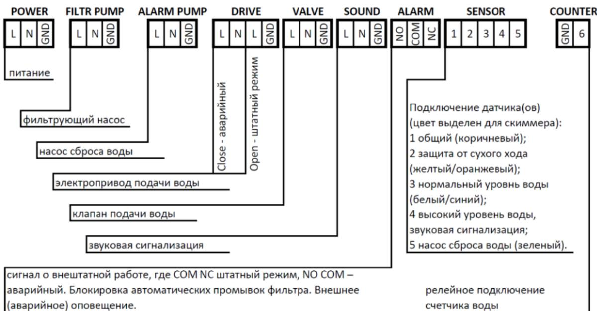
**POWER** - клемма предназначена для подключения питания блока управления и исполнительных устройств подключенных к блоку. **Провод должен быть рассчитан на всю подключенную нагрузку.**
